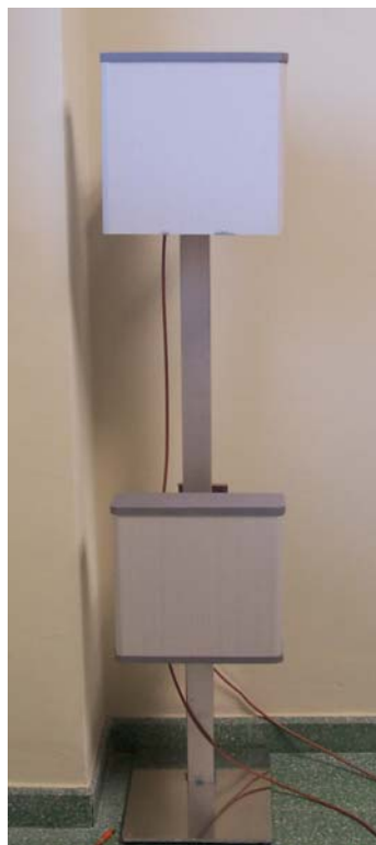
Fig. 3: Antena formada por dos unidades elementales de antena emisora y receptora.
