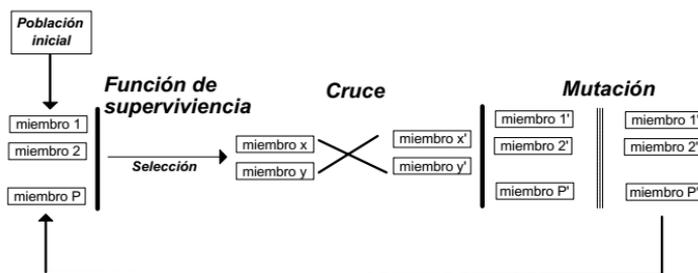
Figura 1: Esquema del algoritmo genético.
