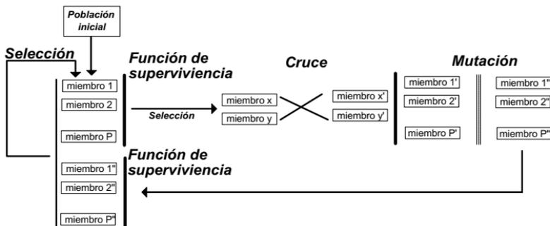
Figura 4: Esquema del algoritmo genético propuesto
