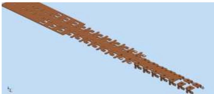
**Fig. 1.3** Diseño de la banda para la fabricación del utillaje progresivo
